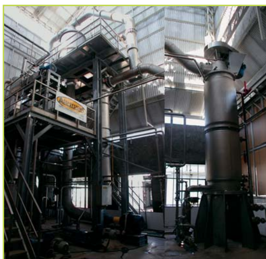
Evaporatore a Circolazione Forzata e a Film Sottile Turbolento
