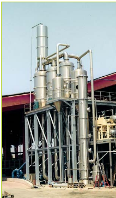
Evaporatore a CF con Recupero degli Aromi e Flash Cooler
