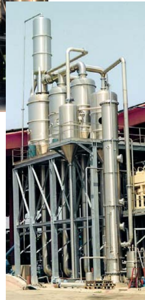
Установка CF с сохранением запахов и быстрым охладителем
