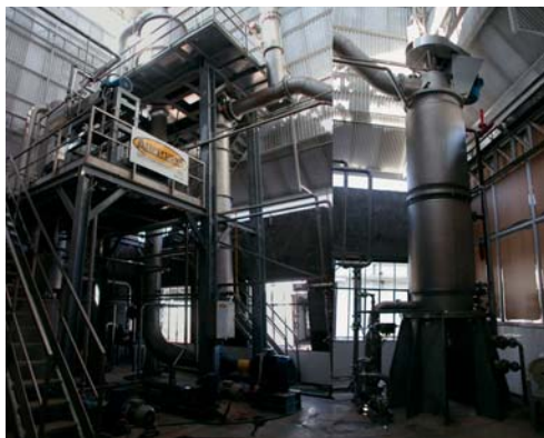
Установка с форсируемой циркуляцией и тонкой изоляционной пленкой A2E2S-MIX 加強循環蒸發機和薄膜流動式蒸發機 A2E2S-MIX
